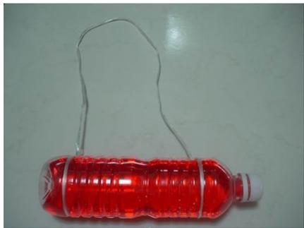
2. 提高到適合高度後開始旋轉，可以發現中間的液面向下凹陷
