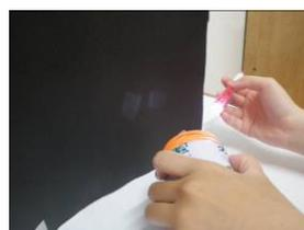
用手電筒照透明片，使光反射在黑紙上，看光的振動情形。
