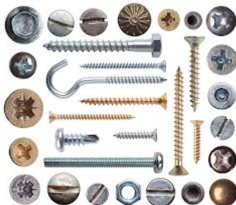
◎螺旋機制能夠將旋轉運動轉換成直線運動，將力矩轉換成直線力。藉著這傳遞作用的機制，作用力可以較放大，施加較小的旋轉力（力矩）於桿軸可以轉換成較大的軸動力。◎螺距是兩條鄰近螺紋之間的軸向距離。螺距越小，則機械利益越大，即輸出力與輸入力的比例越大。
