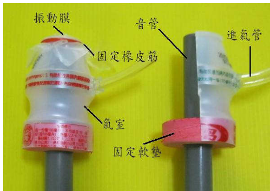
自製「膜鳴」樂器的音管的構造
