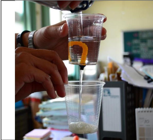
圖三：將水倒入第一杯後發現水倒到一半就往下流倒不滿，流下的水由第二杯盛接。
