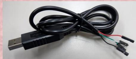
USB 5V 供電 紅線 5V 正電 黑線 GND
