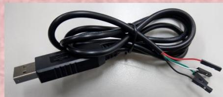
USB 5V 供電 紅線 5V 正電 黑線 GND
