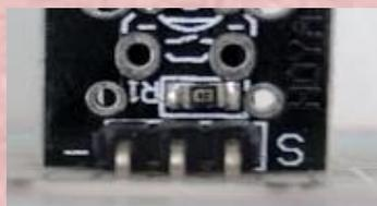
認識 光線感測器(Photoresistor)
