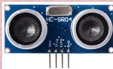
HC-SR04 是一個超聲波感測器，它可以探測的距離為 2cm-400cm，精度為 0.3 cm，感應角度為 15 度。
