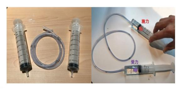
2. 活動二(第二關):將 6ml 的小注射筒不斷重複上拉抽滿水溶液後下壓而將藍色水溶液經由密閉系統的軟式細管將水溶液傳送到 60ml 的大注射筒中,逐漸將藍色水溶液注滿大注射筒,而慢慢將笨重的磚塊抬起來就成功過關!
