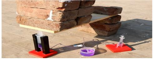
過關小秘訣:將6ml注射筒上拉時不要太用力而不小心將活塞整個拉離開注射筒,要慢慢拉提將注射筒吸滿藍色水溶液後再施力將注射筒活塞向下用力壓到底,不斷將水溶液擠壓傳送到大注射筒,而將其活塞向上推升就可以將笨重的磚塊舉起來喔!
