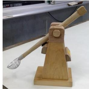
2. **能量守恆**：指彈力位能轉化為動能，使彈丸彈射出去。其可以分成垂直動能與水平動能兩種，垂直動能可使得彈丸彈到較高的位置並得到位能；而水平動能則使彈丸獲得水平方向的初速度，它決定了彈丸可以彈射的距離。
