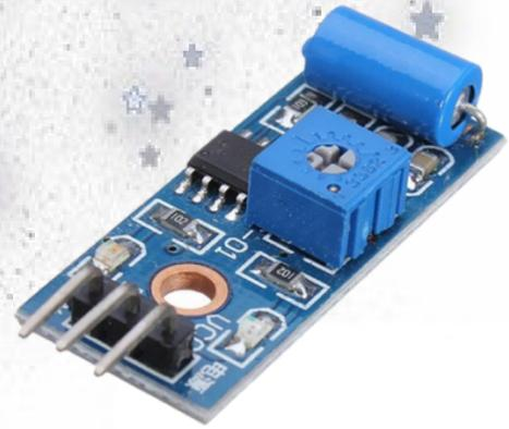
震動感測器是無方向性振動傳感器，當震動感測模組靜止時，電路開啟，輸出為高電位。當發生運動或振動時，電路將短暫斷開並輸出低電位。一般可用在各種震動觸發，例如：防盜，智慧小車，地震等。模組上有一個藍色十字形的電位器調節，可以根據自己的需要調整靈敏度。
