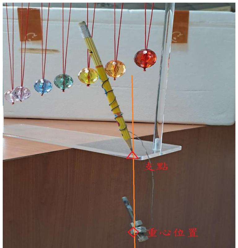
就能穩穩地立在桌角保持平衡！透過螺絲將整組裝置的重心移到筆尖（支點）的下方，就算鉛筆受到擾動以逆時鐘方向傾倒，重心也會自然產生回復力矩（逆時鐘方向），讓鉛筆像不倒翁一樣，即使搖晃～還是能穩定站立。
