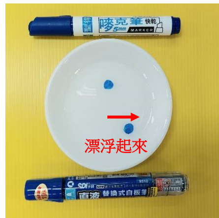
加水到盤子中，白板筆畫的圖案會慢慢浮起來，麥克筆畫的沒有變化
