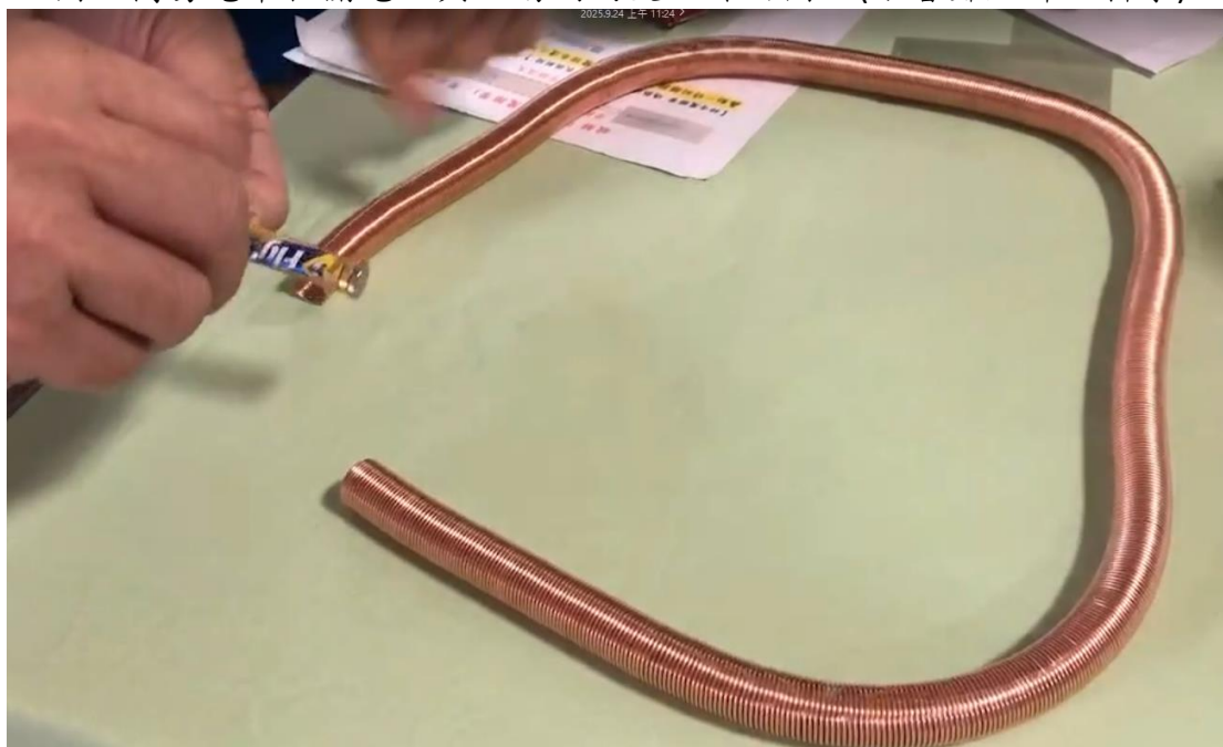
圖 3.簡易電車相關電流與磁場間的交互作用圖示(跟著鄭大師玩科學)
